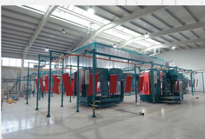
Vytrzovací pec, v které probíhá vytrzování práškových plastů, tvoří jeden celek se sušárnou ulpělé vody. Konstrukčně je provedena obdobným způsobem, avšak je dimenzována na vyšší pracovní teploty a delší dobu setrvání, což ji zvětšuje více jak dvojnásobně. K ochlazování dílců před jejich svěšením z dopravníku je částečně využit volný prostor pod nosnou konstrukcí sušárny a vytrzovací pece.
