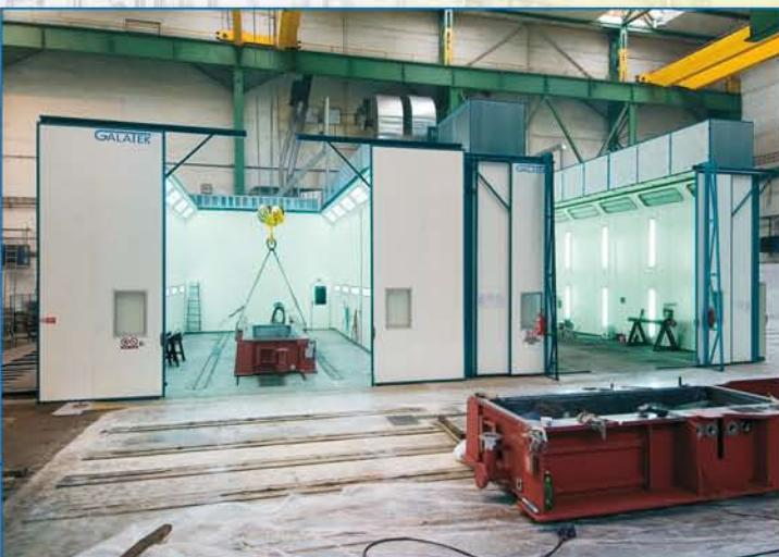
**K**oncem března tohoto roku bylo ve firmě **ROTAS STROJÍRNY spol. s r.o.** uvedeno do provozu pracoviště povrchových úprav rozměrných ocelových konstrukcí. Pracoviště je tvořeno uzavřenou odmašťovací kabinou o velikosti 6x12 m (šxd) s vodním hospodářstvím a čistírnou odpadních vod a roštovou stříkací kabinou o velikosti 8x12 m (šxd) s ekologickým filtrem s aktivním uhlím. Součástí pracoviště je i úpravna nátěrových hmot.
