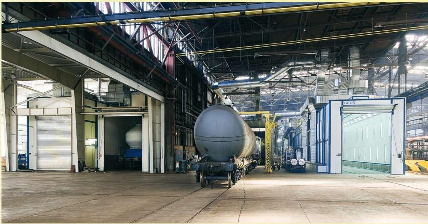
plošinami, obě stříkací kabiny vždy párem pneumaticky poháněných pracovních plošin se třemi stupni volnosti. Délka zařízení je 28 m.
