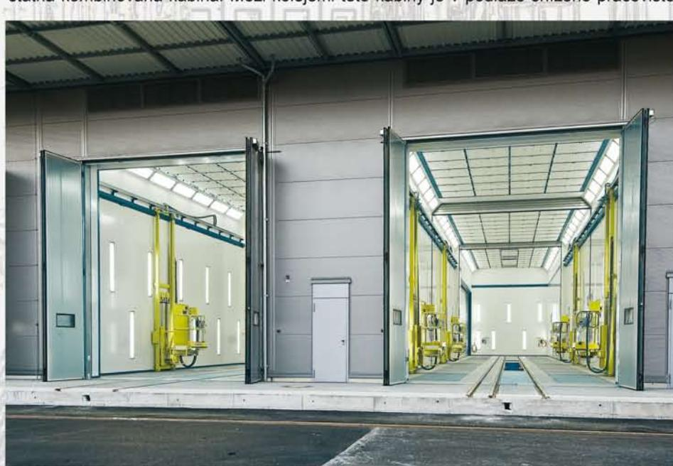
**Pro ruční nástřík menších podskupin ŽKV** je navržena samostatná stříkací kabina. Mezi kolejemi kabiny je v podlaze snížené pracoviště umožňující nástřík spodků vozidel. Kabina má samostatnou větrací vzduchotechniku s rekuperací umístěnou ve strojovně vzduchotechniky na plošině nad kabinou. Větrací vzduchotechnika umožňuje režim stříkání nebo režim stříkání se zvlhčováním.
