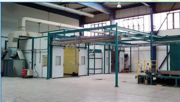
**V**e společnosti **DUKLA Trutnov s.r.o.** jsme ve druhém čtvrtletí tohoto roku instalovali kontinuální linku pro nanášení práškových plastů na tlakové nádoby do průměru 1400 mm. Tato instalace proběhla v rámci rekonstrukce linky z roku 2001. Jednalo se o přestěhování stávající linky a rozšíření o průjezdní postřikový stroj, sušárnu, automatickou kabину pro nanášení práškových plastů s ručním dostříkem, vytvrzovací pec a podvěsný dopravní systémem do nosnosti 350 kg.
