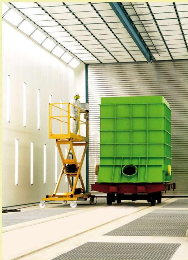
stříkací kabina vybavena pracovními plošinami s pneumatickým ovládáním zdvihu. Přesun těchto plošin v prostoru stříkací kabiny je ruční.
