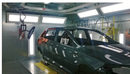
Stříkácí kabina Spotrepair, IR zářiče pro sušení laku - 2
