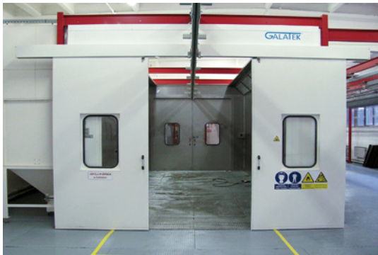
Pracoviště pro předúpravu povrchu a nanášení práškových plastů, Incolour s.r.o.
