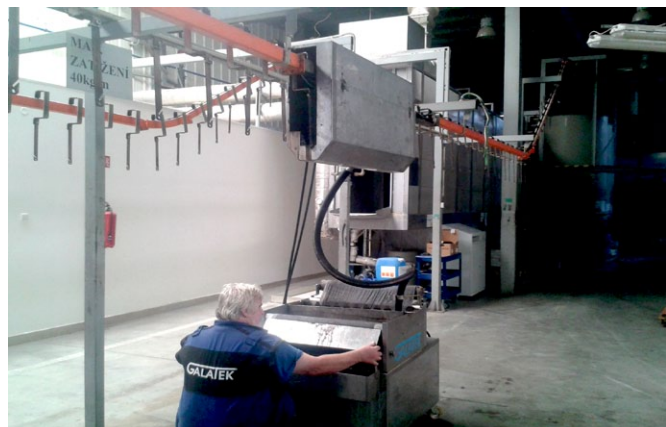
Čištění dopravníkového řetězu
