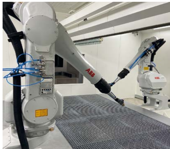
Robotická kabína s oboustranným lakováním
