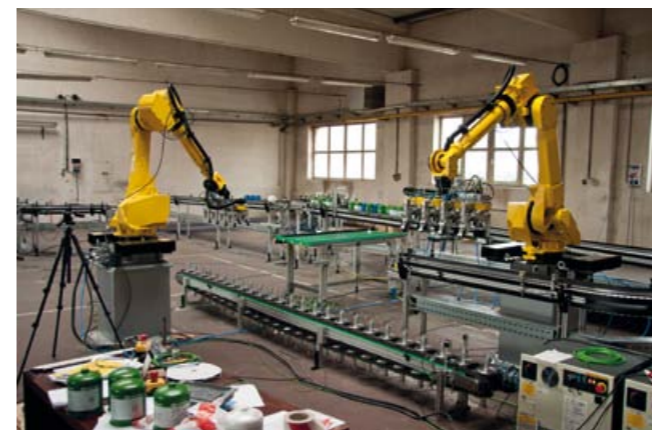
Testování automatického zakládání
