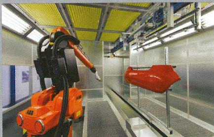
Stříkací kabina s robotem ABB
