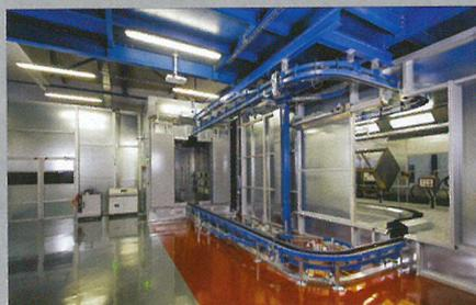
Navěšovací a svěšovací pracoviště s podvěsným i podlahovým dopravníkem
