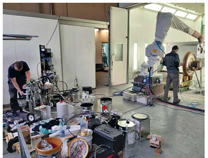
Průběh zkoušek robotického lakování železničního dvojkolí
