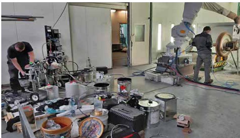
Průběh zkoušek robotického lakování žel. dvojkolí
